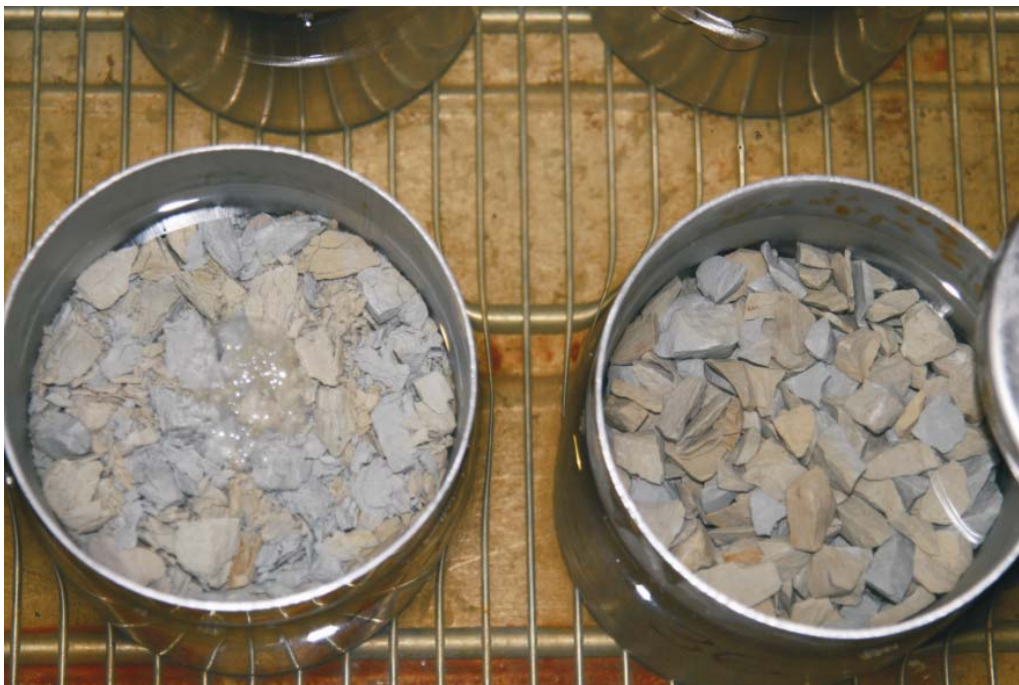
Foto 1. Lubjakivikillustik pärast 9 külmutus-sulatustsüklit 1% NaCl lahuses (vasakul) ja destilleeritud vees (paremal).
