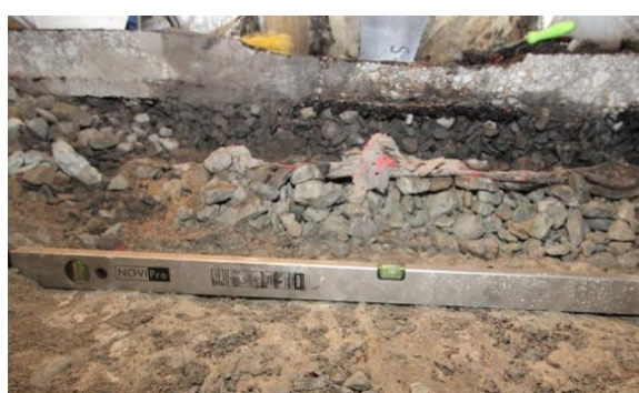
Joonis 13 – Pärast katset heas seisukorras graniidist killustikalus
