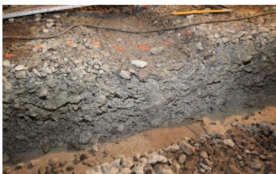
Joonis 12 – Pärast katset purunenud ja deformeerinud lubjakivikillustikust alus
