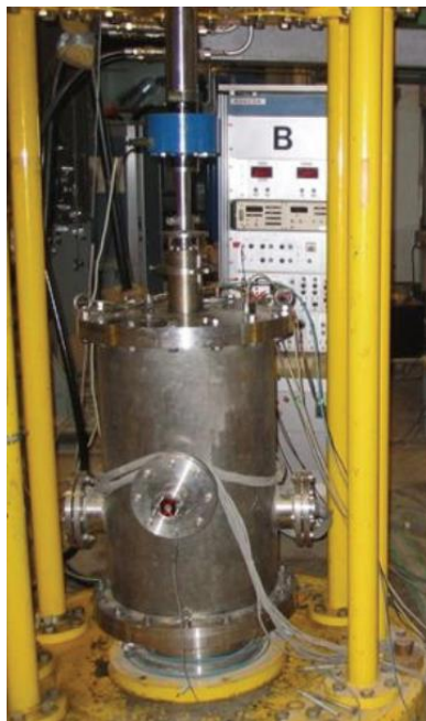
Joonis 17 - Kolmetelgse tsüklilise surveteimi katseseade
